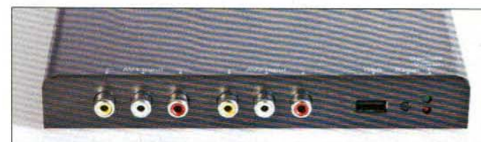
Offen für alles: Per Cinchbuchsen nimmt der DVBT 400 zwei A/V-Quellen an die Leine, über den USB-Port können MP3s sowie Videos im MPEG4- oder DivX-Format eingespeist werden.
