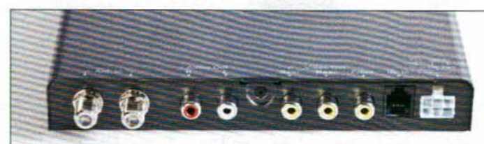
Doppelt und dreifach: Antennenanschlüsse gibt es zwei, das Videosignal kann gleich an drei Cinchbuchsen abgegriffen werden. Dazu gesellen sich der Ton-, Strom- und Infrarotaugen-Anschluss.
